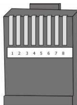
На левой панели батареи имеется четыре интерфейса RJ45. Интерфейсы RS485 и CAN вверху предназначены для подключения к инвертору. Интерфейсы RS485 внизу используются для подключения к другим батареям. Ниже приведена распиновка разъема RJ45 для батареи.
