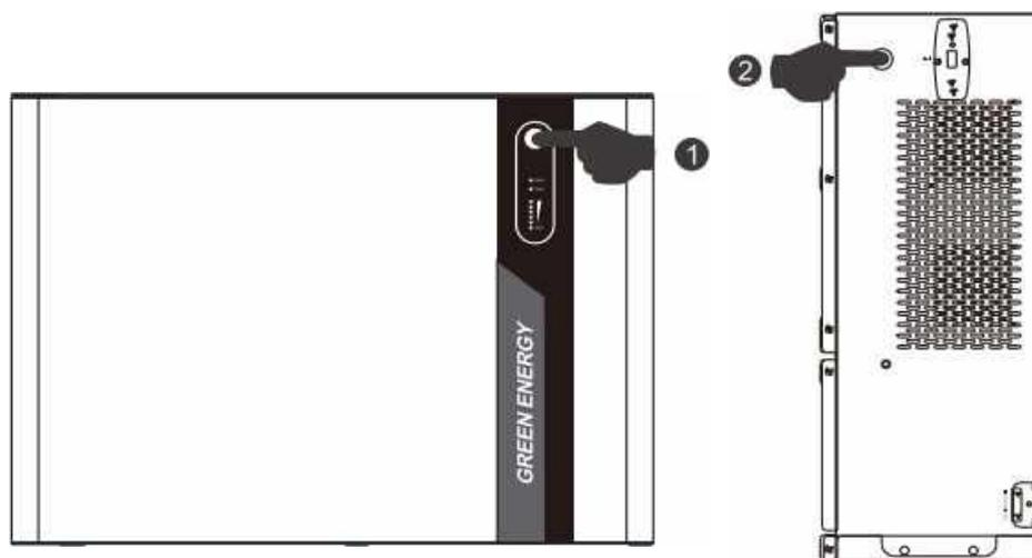
Шаг 2: Когда индикаторы RUN и SOC батарейных модулей загораются, нажмите выключатель ВКЛ/ВЫКЛ на правой стороне инвертора, чтобы включить устройство.
