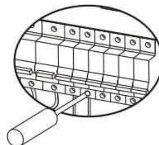
4. Затем вставьте провода переменного тока в соответствии с полярностями, указанными на клеммном блоке, и затяните винты клемм.
