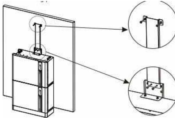
Шаг 6: Повесьте инвертор на крепежные панели, настройте всю систему и убедитесь, что батарея и инвертор надежно висят на панелях и кронштейнах.
