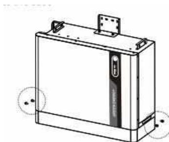
Шаг 3: Разместите батарею параллельно стене и используйте дрель для сверления отверстий на глубину около 70 мм в стене для последующей фиксации крепежных пластин. Удалите заглушку для мусора и закрепите батарею на стене с помощью винтов.
