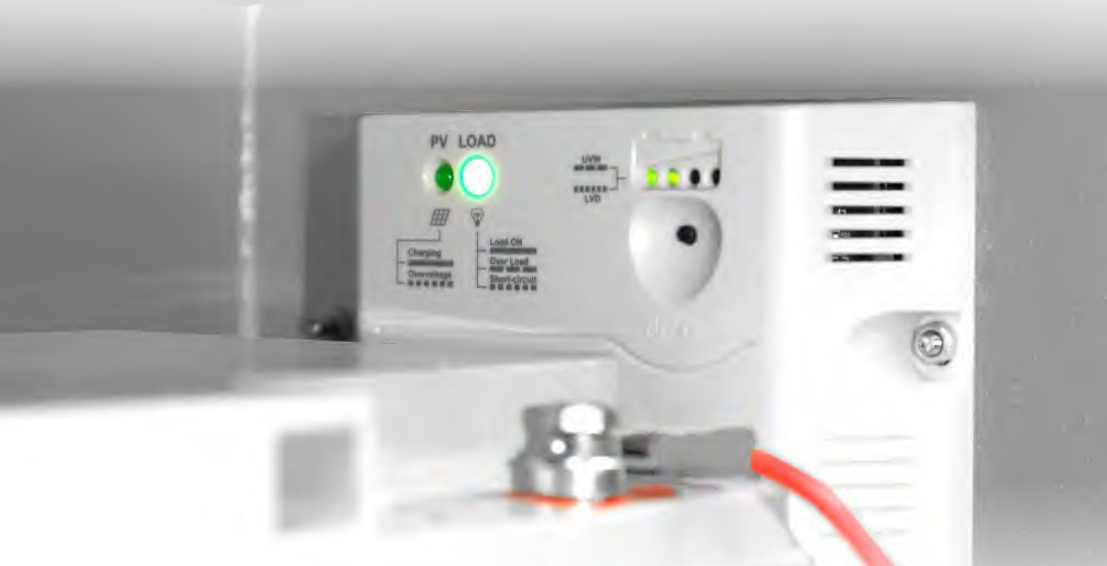
1.6. Для активации работы солнечной электростанции подключить кабельные вводы солнечной панели (1) к разъемам соединительного кабеля ящика АКБ (2).
