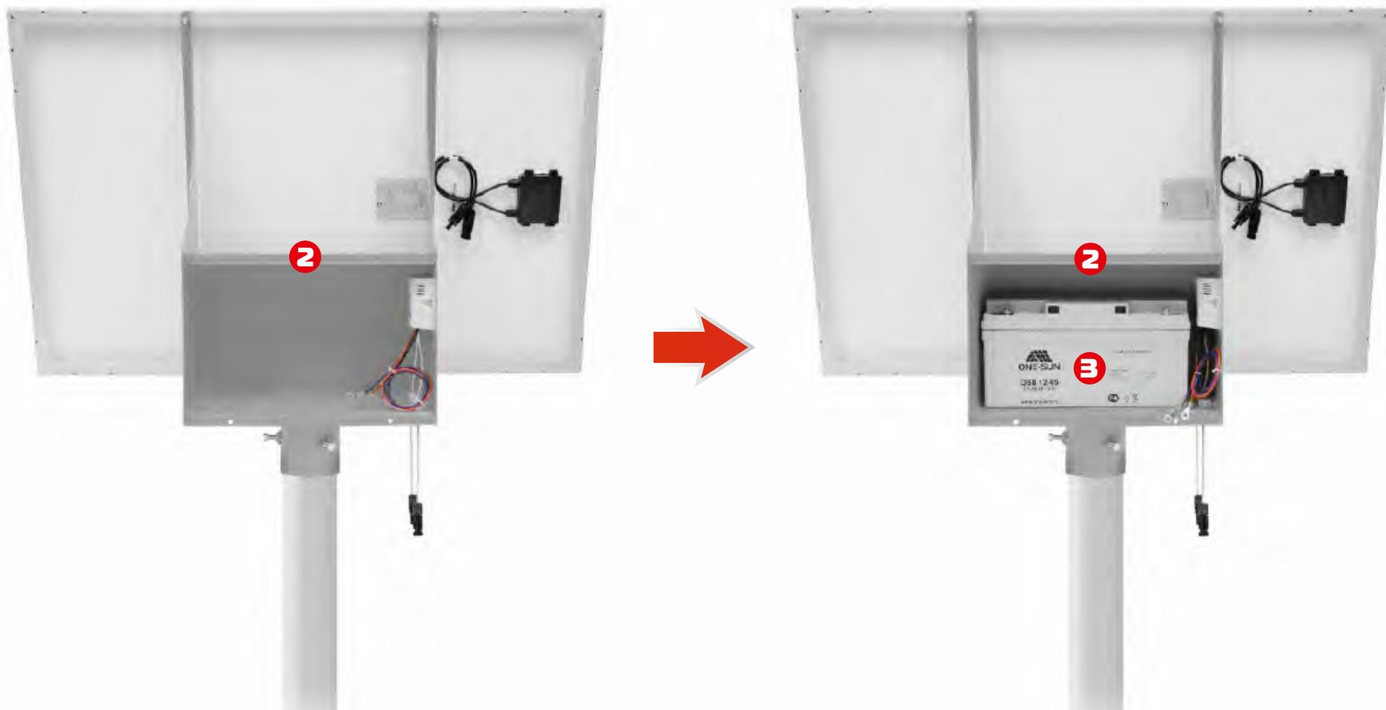
1.4. Подсоединить к клеммам аккумулятора кабель, идущий от клемм контроллера, как показано на схеме 1.
