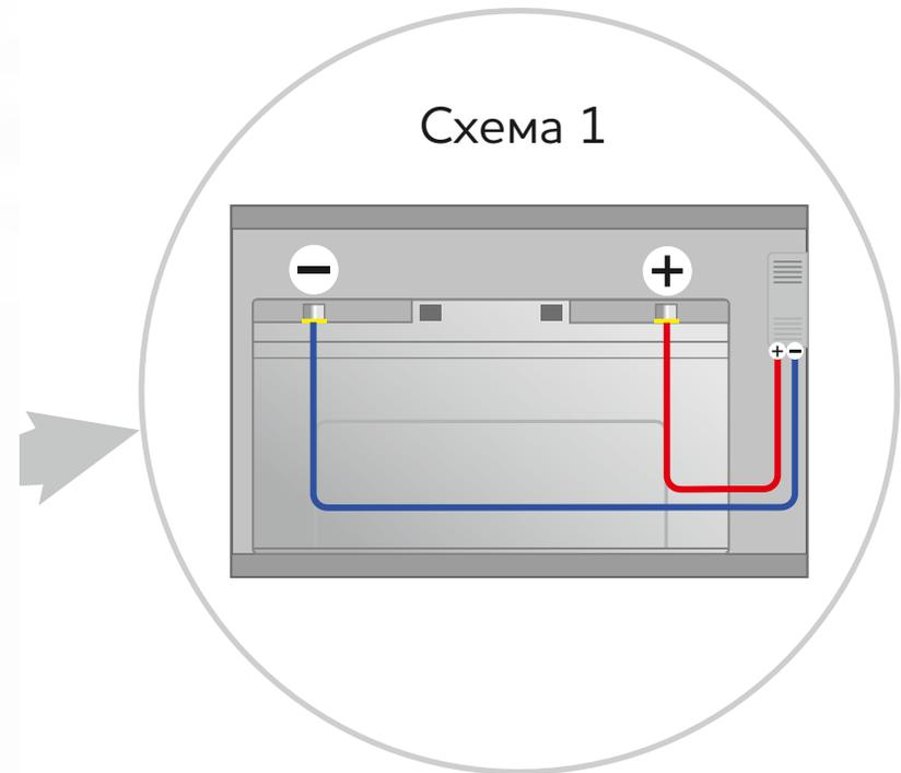
1.5. При правильном подключении аккумуляторной батареи, на контроллере загорается зеленый индикатор «LOAD».
