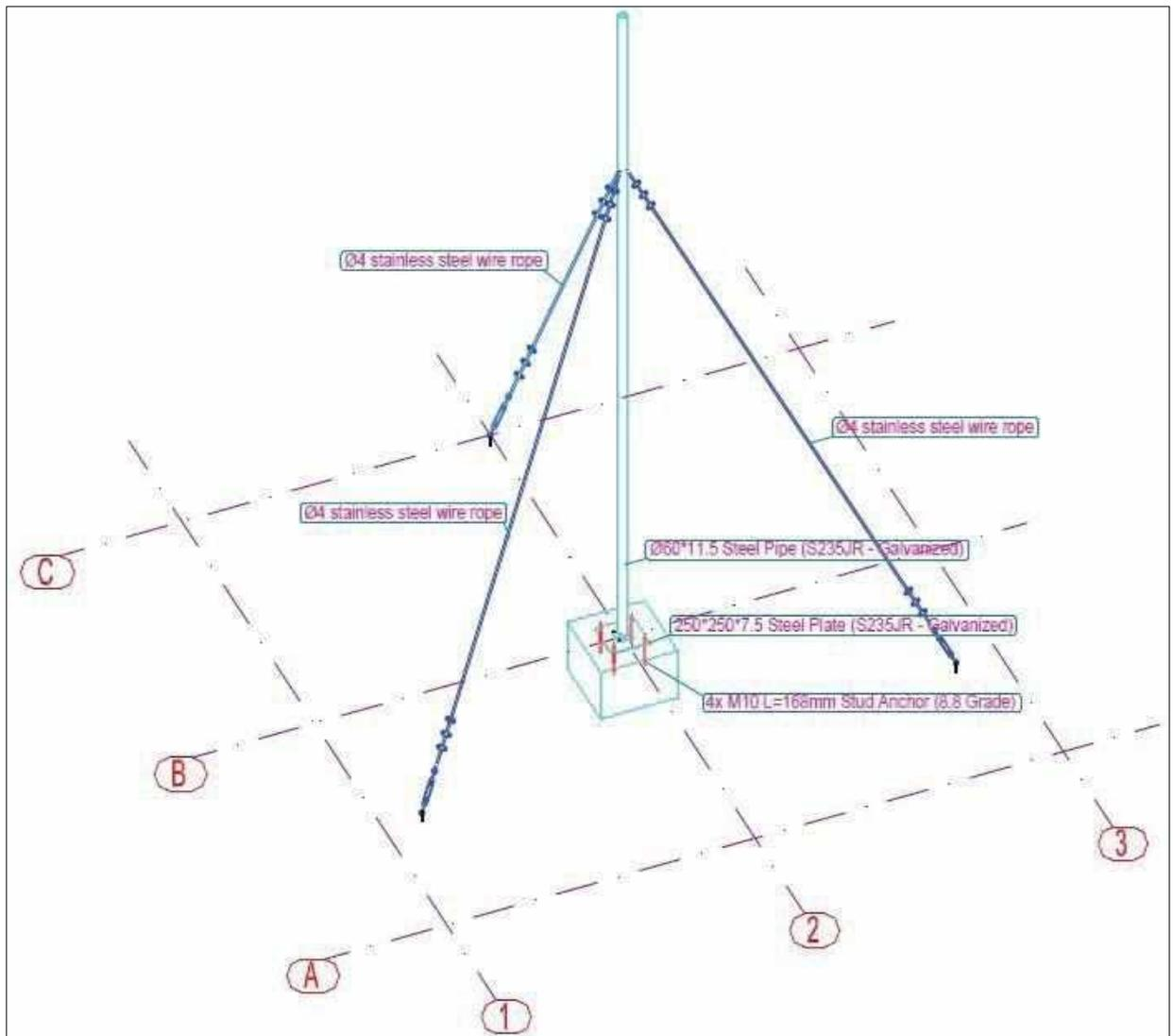
Рисунок 7 – Схема основания для установки мачты.
