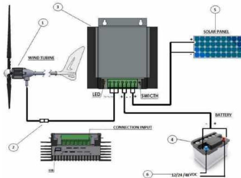
Рисунок 1 – Схема устройства ветроэлектрической установки.
